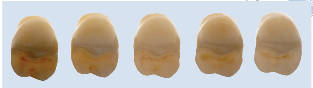
Abb. 24 Gegenüberstellung der verschiedenen Zirkonoxid-Generationen im Vergleich zu \text{LiSi}_2 -Keramik (v. l. n. r.: 1. Generation, 2. Generation, 3. Generation, \text{LiSiO}_2 LT und \text{LiSiO}_2 HT).
